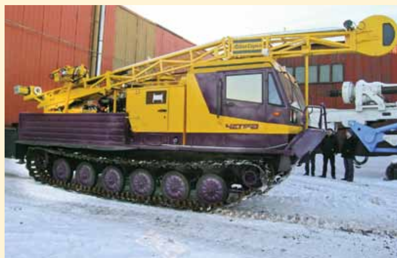
▲ На снимке: вездеход с буровой установкой «Atlas Copco»
